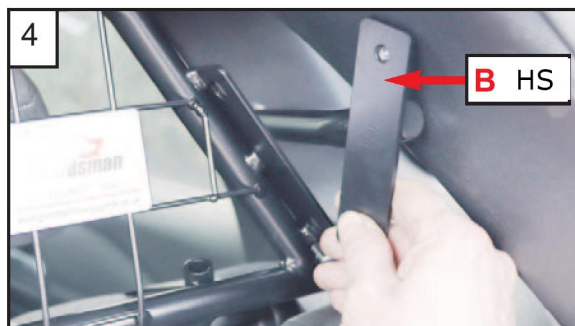
4 Sett på arm på høyre side (B) med skruer (C). Ikke stram
