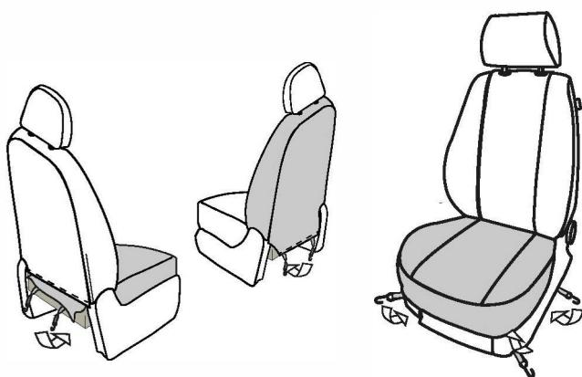
Monteringen varierer avhengig av setemodellen. Fest metallkrokene i de elastiske løkkene og prøv å matche dem med løkkene som ligger rett overfor under setet, hvis mulig. Fest de øvrige løkkene rundt på samme måte som vist på bilde 10.
