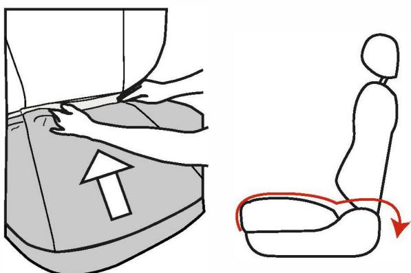
Trekk på setet; før stoffet bakpå gjennom mellom ryggstøtten og setet.
